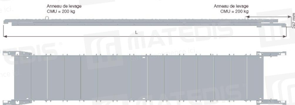
Les escaliers sont superposables. Pour prévenir le basculement et garantir le bon maintien d'un ensemble, les anneaux de levage peuvent servir de maintien. Vérifier que les anneaux de levage soient solidaires avec l'escalier.
